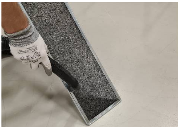
Abb. 42: Filter absaugen und nach dem Reinigen wieder einsetzen.
