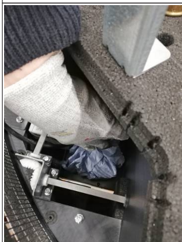
Abb. 36: Pumpensumpf reinigen
